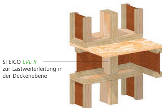
F5 Weiterleitung hoher Einzellasten durch die Deckenebene
