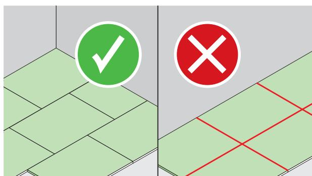
Die Verlegung von STEICO Verlegeunterlagen erfolgt im losen Verband mit einem Stoßversatz von einer halben Platte. Kreuzfugen müssen vermieden werden. Eine um 45° zum Belag gedrehte Verlegerichtung kann die Leistung der Verlegeunterlage verbessern. Bei T-Stößen können die Platten mit einem handelsüblichen Klebeband gegen Verrutschen gesichert werden.
