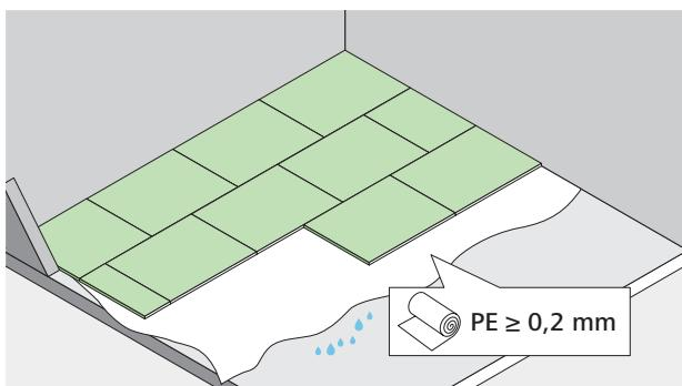
Auf allen mineralischen Untergründen, die frisch eingebracht wurden oder noch eine Kernfeuchte enthalten, muss vollflächig eine Feuchtesperre verlegt werden (z.B. geeignete PE-Folie). Sie schützt die Verlegeunterlage und den Bodenbelag vor aufsteigender Restfeuchte aus der Betondecke. Die Bahnen müssen sich ausreichend überlappen.
