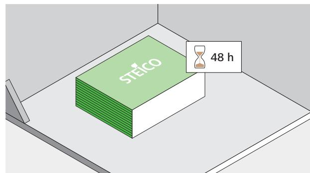
Die Lagerung erfolgt liegend, auf ebenem Untergrund und in trockener Umgebung. Eine Beschädigung von Platte und Verpackung ist zu vermeiden.
