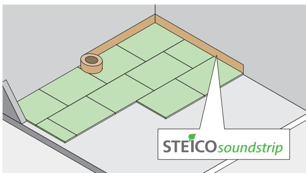
Der Bodenaufbau muss über seine gesamte Höhe an allen aufsteigenden Bauteilen durch einen Randdämmstreifen entkoppelt werden. Wir empfehlen STEICO*soundstrip* aus natürlicher Holzfaser
