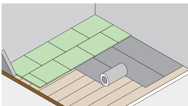
Auf einer Holzdecke wird ein geeigneter Rieselschutz (z.B. Kraftpapier) zwischen Decke und Verlegeunterlage empfohlen. So kann kein loses Material in das darunterliegende Geschoss gelangen.
