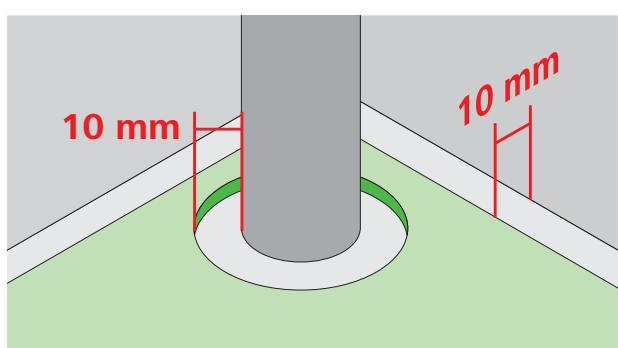
Zu aufgehenden Bauteilen und Durchdringungen muss mit der Verlegeunterlage ein ausreichender Randabstand eingehalten werden. Empfohlen werden 10 mm.
