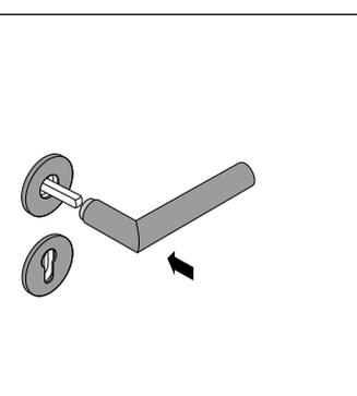
Zur Demontage mit beiliegendem Werkzeug von unten den Klemmmechanismus entriegeln und Drücker abziehen. Mit Hilfe eines Rosettenhebers die Deckrosetten von den Unterkonstruktionen abklippen.
