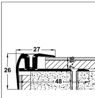
**Treppenkantenprofil Typ 203**
